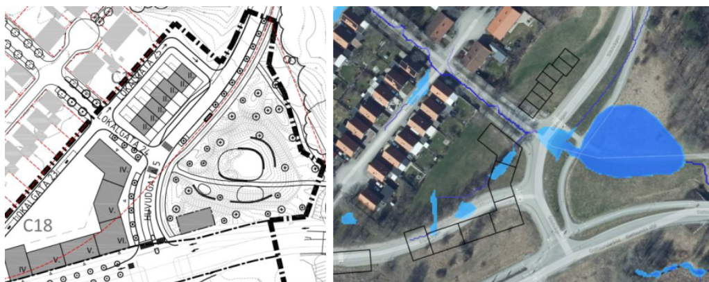
Bild 27 Till vänster: Ny strukturplan och översvämningssyta öster om Slädvägen. Översvämningssytan är multifunktionell då den i normala fall kan fungera som parkyta för rekreation och lek och kan översvämmas vid extrema regn. Till höger: Ny höjdsättning med översvämningssyta är modellerad. Denna leder till förbättrad situation för befintlig bebyggelse samt möjliggör ny struktur. Höjdsättning och markmodellering av översvämningssytan pågår i förprojekteringen, men analysen visar principen av sänkt tröskel och effekten för befintlig och ny bebyggelse.
