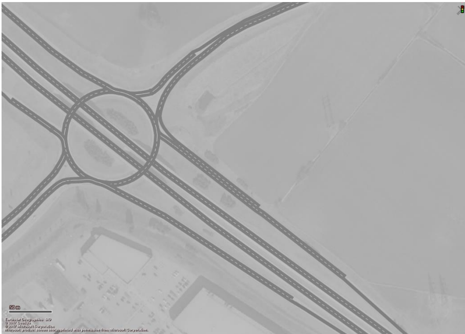
Figur 22. Fritt högersvängsfält från rampen.
