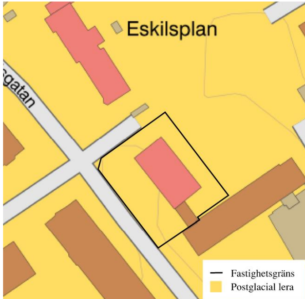
Figur 1: Jordartskarta över fastigheten. Källa: SGU – Sveriges Geologiska Undersökning.
