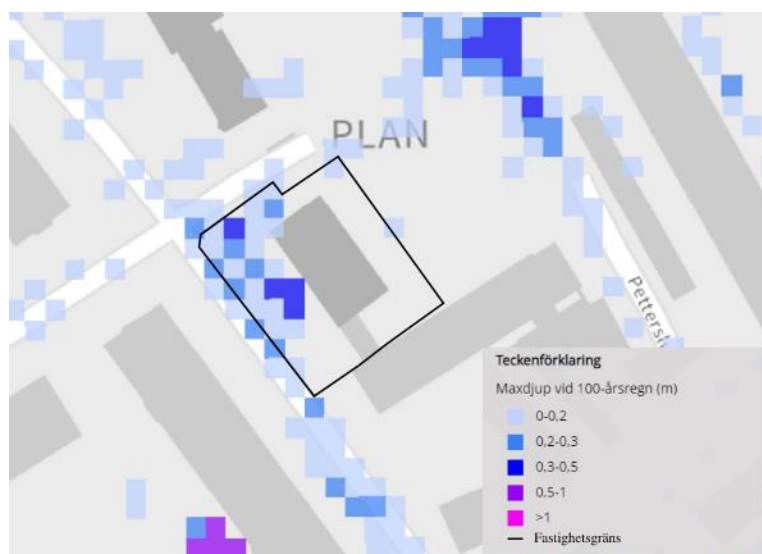
Figur 4: Lågpunktskartering över fastigheten. Källa: Uppsala vatten
