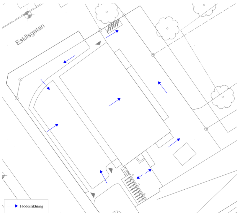
Figur 3: Ytliga avrinningsvägar vid befintlig situation.
