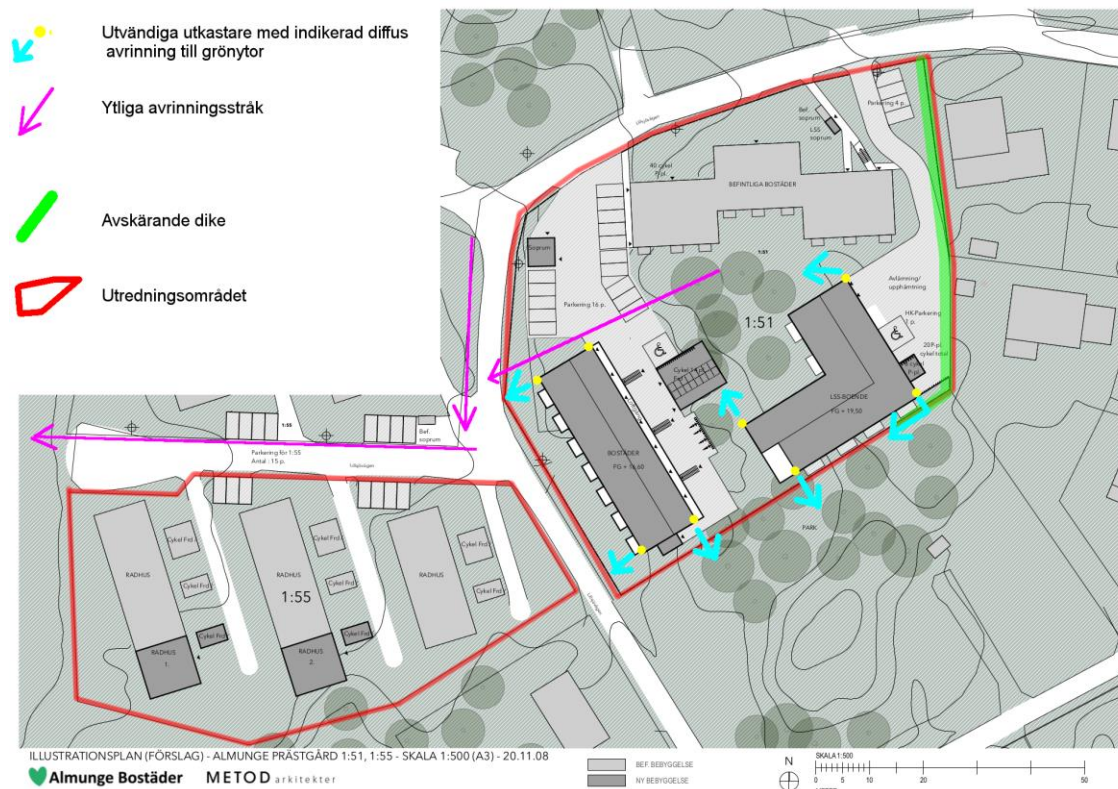
Figur 9. Förslag på dagvattenhantering genom diffus avrinning till grönyta via stuprör. Denna figur uppdaterades i samband med bilaga. Se bilaga för ytterligare förklaringar i text.
