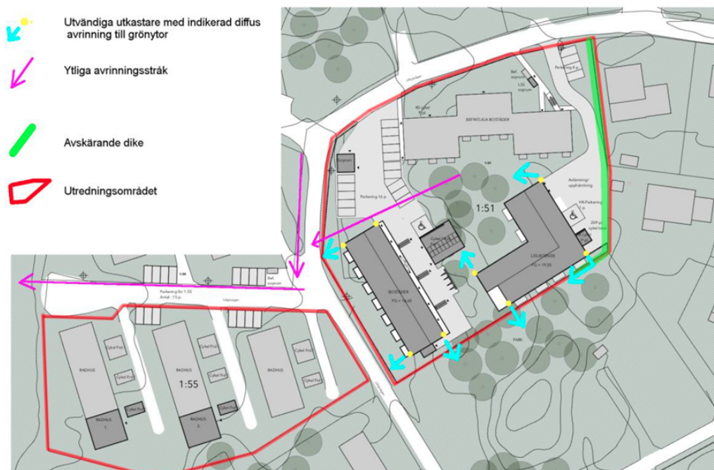
Bild 21 Bild som visar förslag till dagvattenhantering. WSP.
