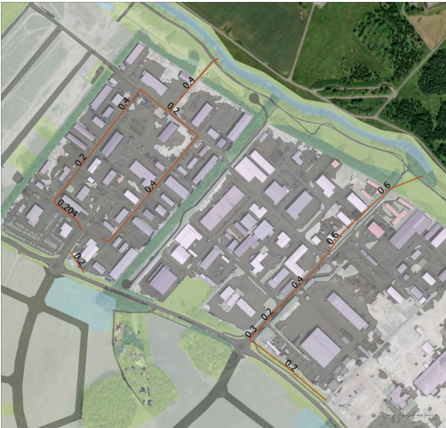
Figur 5. Delar av det befintliga ledningsnätet som planeras att dimensioneras upp. Figuren visar ökningen (m) i dimension.
