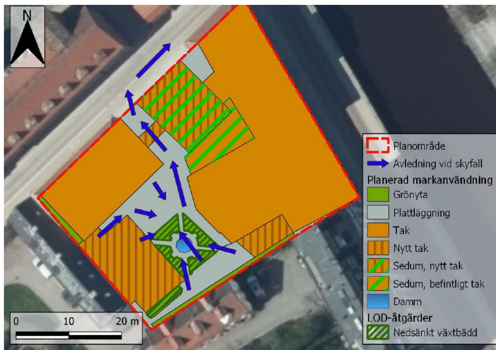
Figur 50 Karta som visar förslag på avledning av skyfallsflöden efter exploatering. Ortofoto: © Lantmäteriet (2021). Källa: Dagvattenutredning, WRS.
