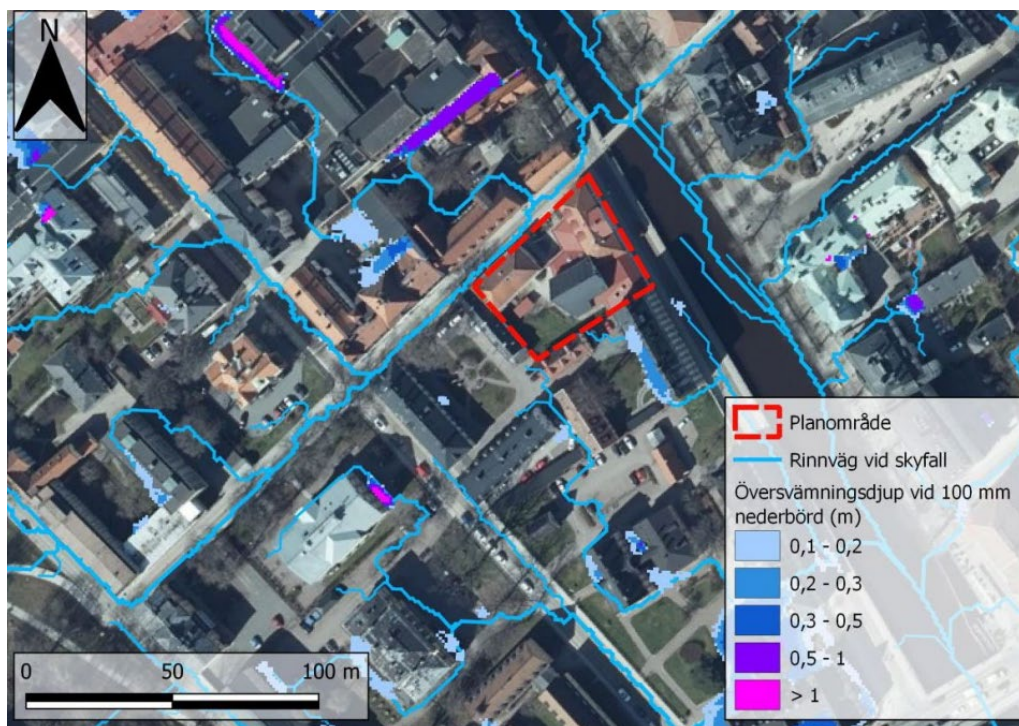
Figur 49 Karta som visar rinnvägar och lågpunkter med vattendjup större än 0,1 meter. Planområdet är markerat med rödstreckad linje. Inga lågpunkter kan ses inom planområdet. En rinnväg bildas vid skyfall norr om planområdet längs Slottsgränd. Källa: Scalgo (2023). Ortofoto: © Lantmäteriet (2021).
