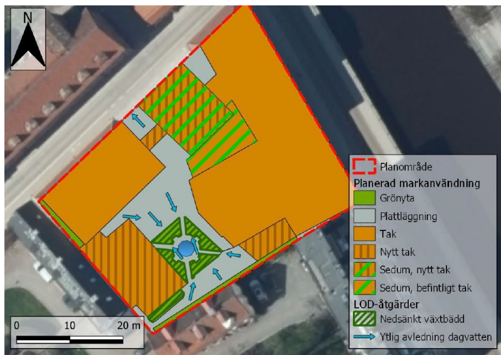
Figur 46 Illustration över föreslagen dagvattenhantering inom planområdet. Källa, Dagvattenutredning, WRS. Ortofoto: © Lantmäteriet (2021).
