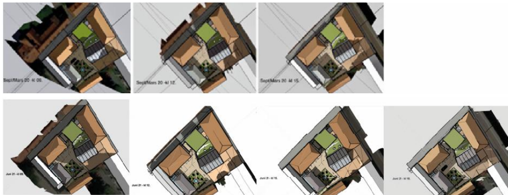
Figur 55 Bild som visar sol- och skuggförhållandena efter byggnation under september/mars (övre raden) och juni (nedre raden), kl. 09:00, 12:00, 15:00 och 18:00. Källa: Arkitektstudio MN.
