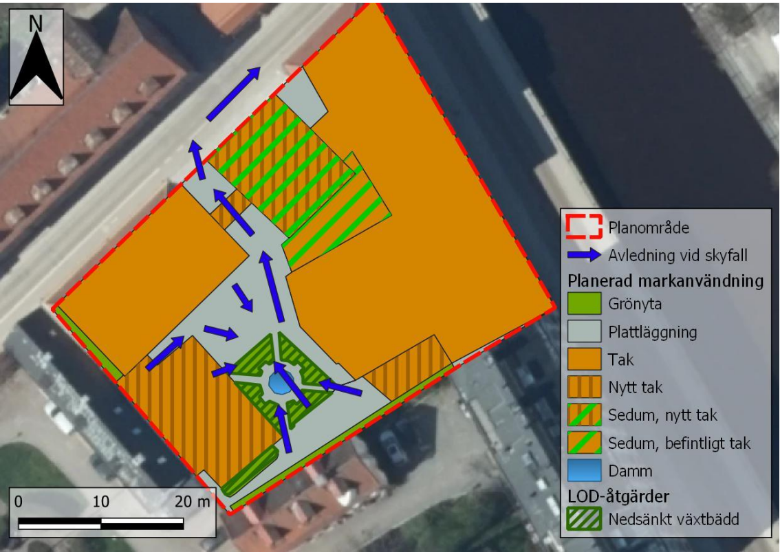
Figur 20. Förslag på avledning av skyfallsflöden efter exploatering. Ortofoto: © Lantmäteriet (2024c).
