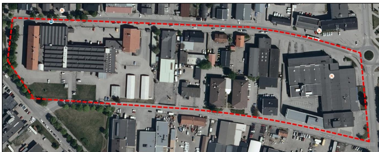
Figur 4-1. Befintlig markanvändning i ett av kvarteren inom utredningsområdet. Kvarteret studerades för att erhålla en lämplig avrinningskoefficient för kvartersmarken.
