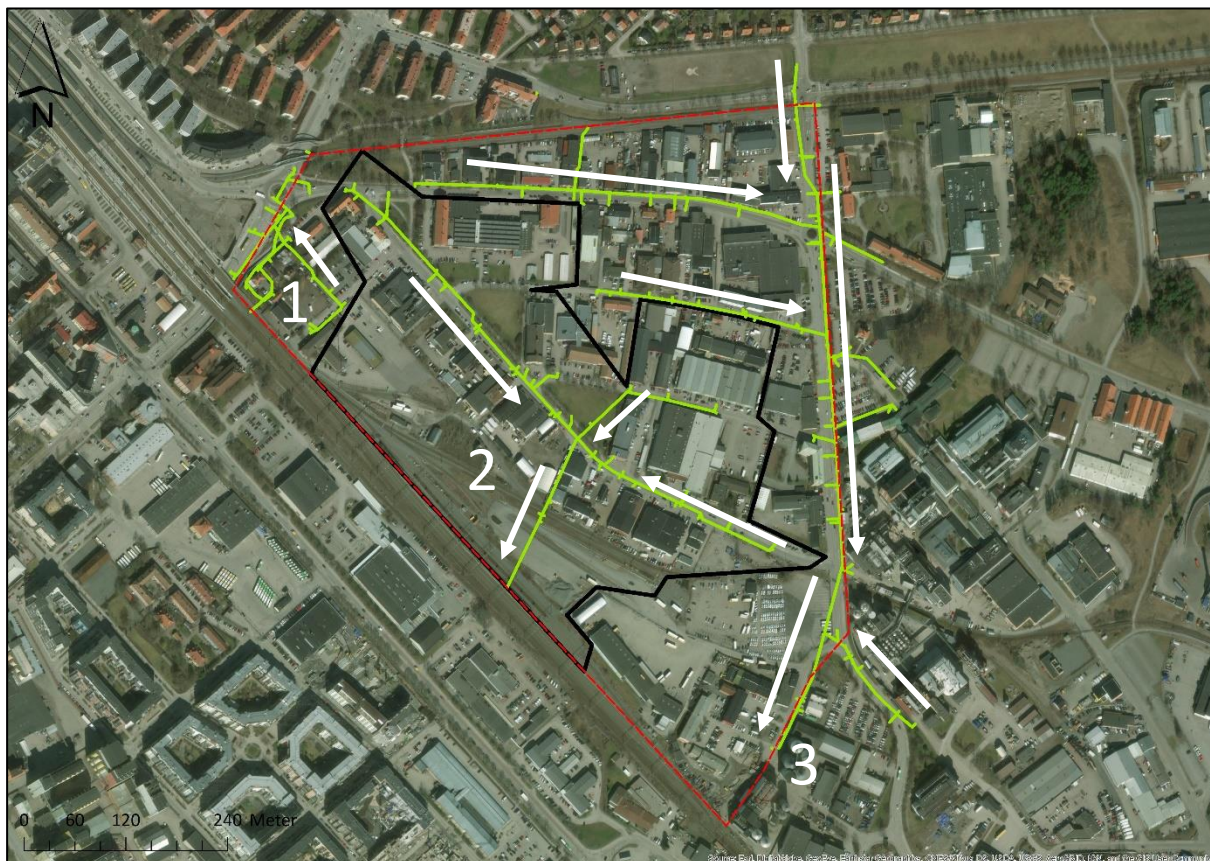
Figur 3-5. Det befintliga dagvattennätet (gröna linjer) samt flödesriktningarna i dagvattenledningarna (vita pilar). Svarta linjer representerar de befintliga tekniska delavrinningsområdena. Området avvattnas via antingen dagvattenledning 1, 2 eller 3.
