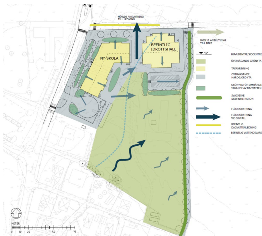
Bild 42 Situationsplan som visar förslag till dagvattenhantering.
