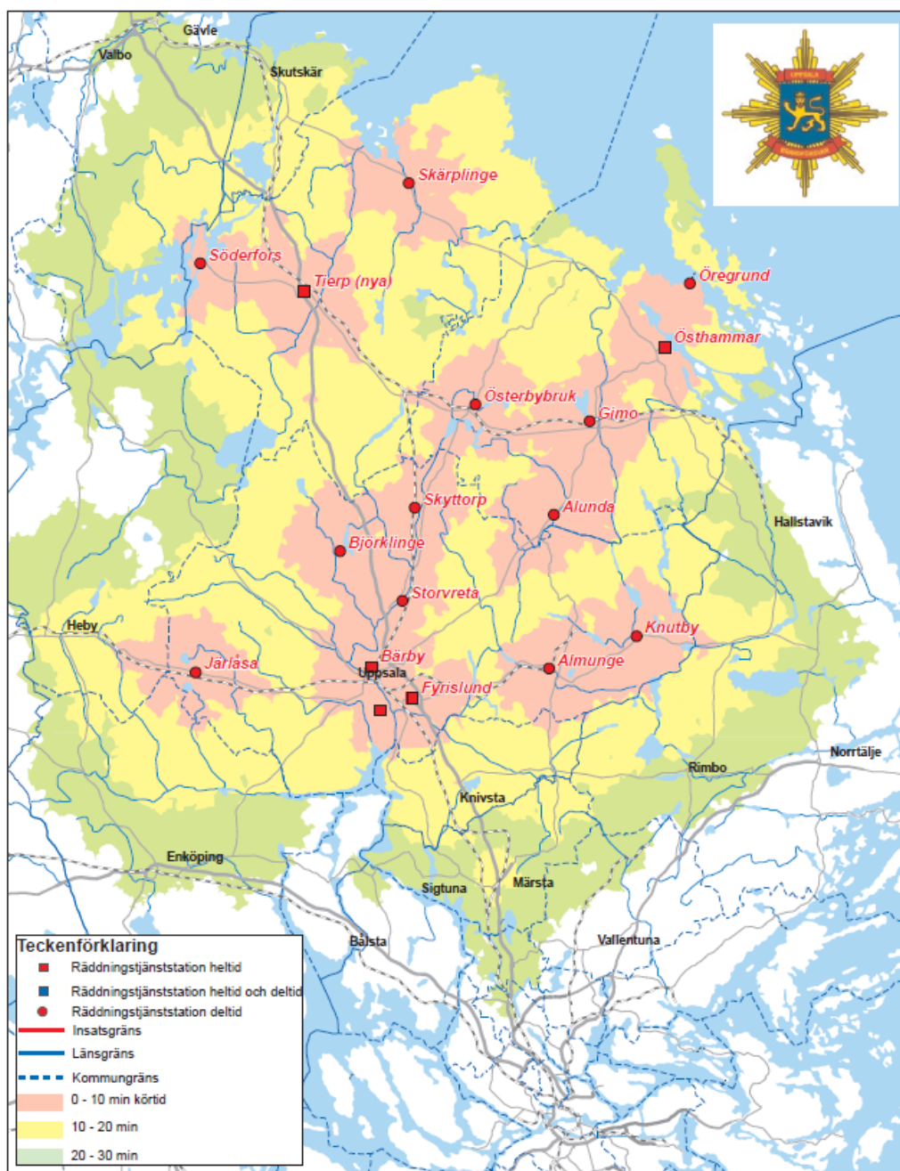
Figur 9.3.1.1. Insatstider i Uppsala brandförvars geografiska område med dagens organisation. Figuren visar tiden till dess att första enhet är framme på plats och skadeavhjälpanande åtgärder påbörjas. För RiB-stationerna avser detta FiP-enheter. I kartan är utgångspunkten för alla enheter respektive brandstation. För RiB-stationerna är zonerna ungefärliga då inte FiP-enheterna normalt sett utgår från brandstationen utan från den plats personen som bemannar enheten har beredskap för stunden befinner sig.
