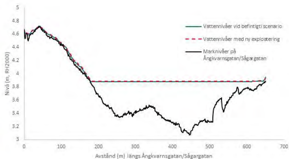
Figur VI: Till vänster läge för profil längs Ångkvarnsgatan och Sägargatan och till höger profil med beräknade vattennivåer vid befintligt scenario samt ny exploatering jämfört med marknivån från laserskanningen.
