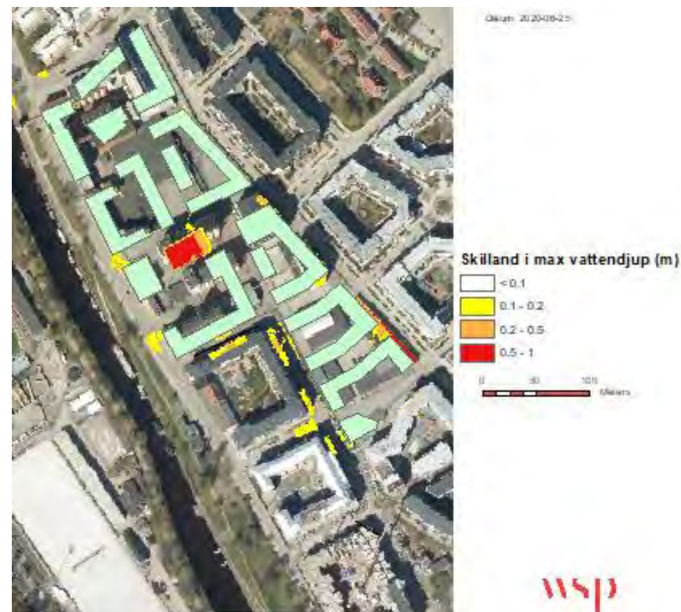
Figur V: Skillnad i maximalt vattendjup mellan maximalt beräknade vattennivåer med ny exploatering minus vid befintligt scenario. I figuren redovisas de platser som har mer än 1 dm skillnad.
