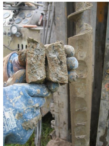
Foto 42. Vattenkanal i lera
