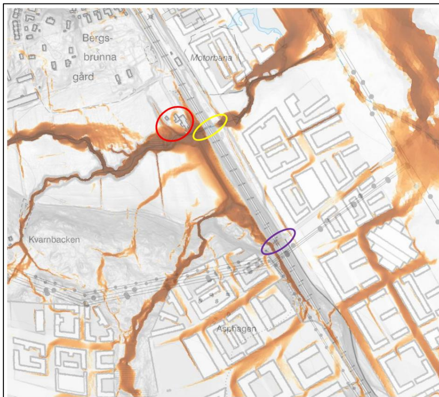
Figur 3. Utklipp från dagvattenutredning för Sävjaån 2 , resultat från skyfallsanalys för sydöstra stadsdelarna. Bebyggelse där översvämningsrisken beräknas öka (om inte åtgärd görs) markerad med röd ring. Befintlig järnvägsskylvert, som eventuellt kommer ersättas med en större viltpassage (vilket löser problemet men medför andra konsekvenser nedströms), markerad med gul ring. Gångtunnel under järnväg med osäkra nivåer markerad med lila ring. Detaljplan Gårdsvägen ligger direkt norr om röd och gul ring.
