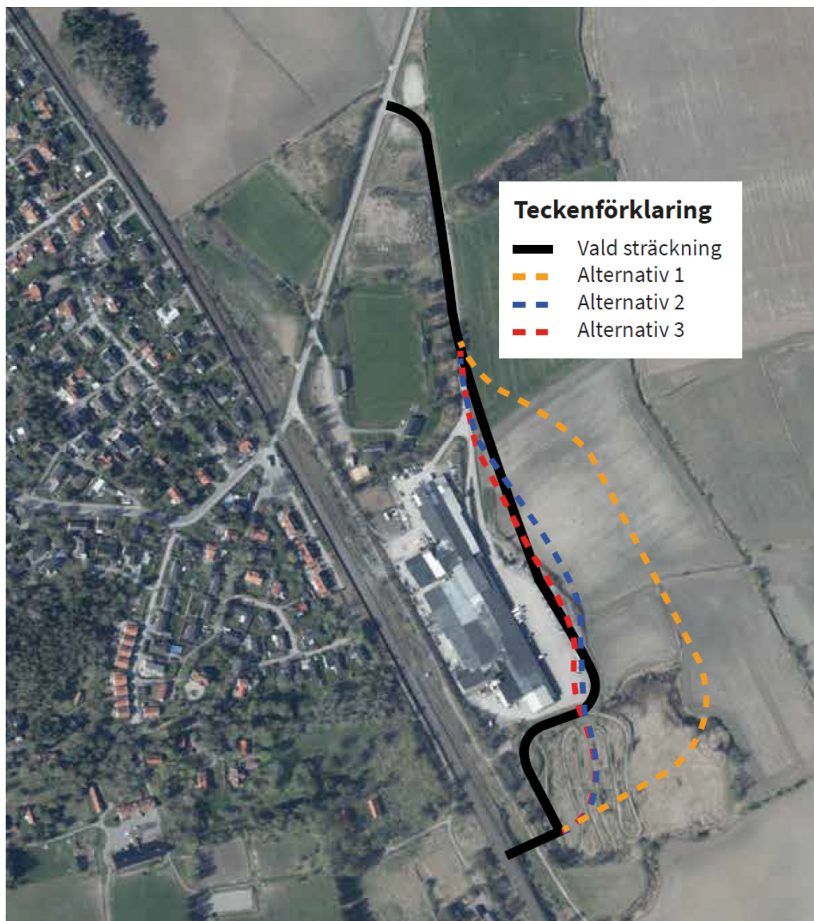
Figur 1 Karta över valt alternativ och bortvalda alternativ för vägens dragning öster om järnvägen.
