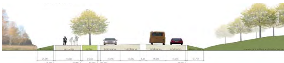
Föreslagen principsektion för ny anslutningsväg till Storvreta
