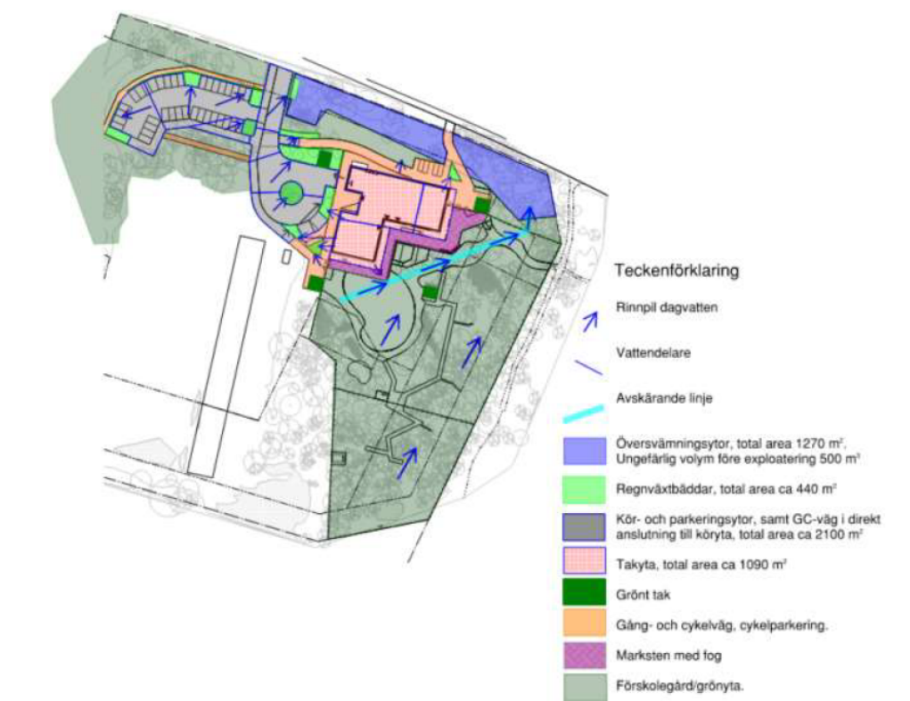
Figur 35 Urklipp från dagvatten-PM (Bjerking 2022) som redovisar föreslagen dagvattenhantering för ny förskola med 8 avdelningar.
