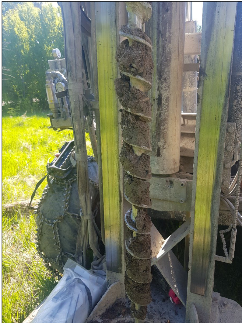
Figur 12. Foto på jordlagerprofilen i provpunkt 22A001 på 0-1 m djup där föroreningshalter >KM påträffades. Foto: Erika Hagerfors, AFRY.
