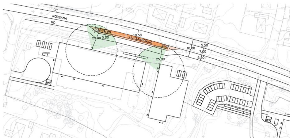
Figur 32 Angöringslösning till Uppsävjaskolan anpassad efter gatusektion enligt intentioner i den fördjupande översiktsplanen för de sydöstra stadsdelarna. Orange yta markerar en flexyta avsedd för färdtjänst, buss och parkering för rörelsehindrade (besökare).
