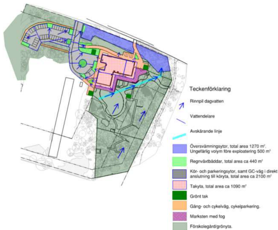
Figur 35 Urklipp från dagvatten-PM (Bjerkning 2022) som redovisar föreslagen dagvattenhantering för ny förskola med 8 avdelningar.
