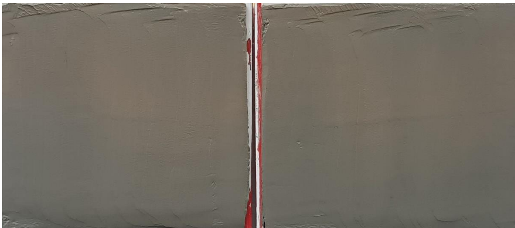
Figur 3 Borrpunkten, 21B06, 9,0 m, Jordprovet i nedre delen av mellanhylsan delad longitudinellt provhylsan med id Bjerking 949.
