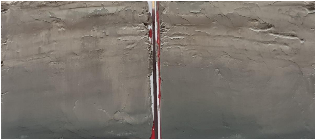
Figur 2 Borrpunkten, 21B06, 6,0 m, Jordprovet i nedre delen av mellanhylsan delad longitudinellt provhylsan med id Bjerking S 632.
