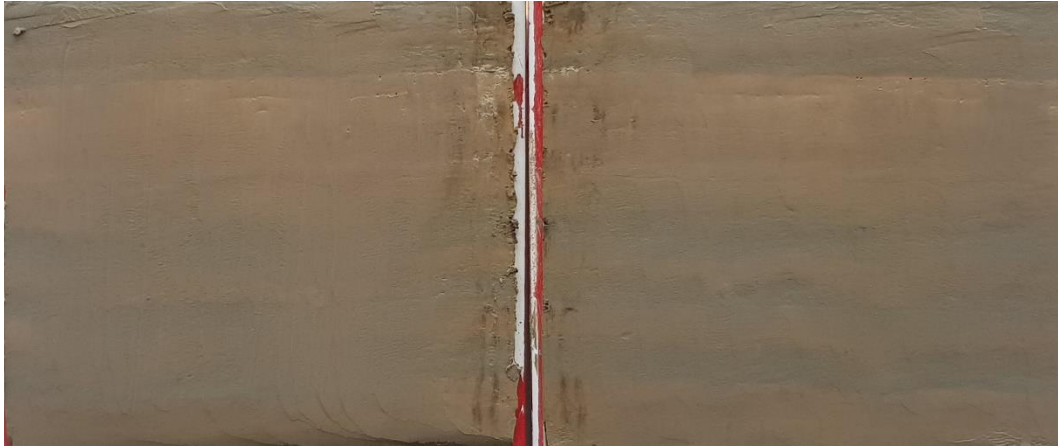
Figur 1 Borrpunkten, 21B06, 3,5 m, Jordprovet i nedre delen av mellanhylsan delad longitudinellt provhylsan med id Bjerking 478.
