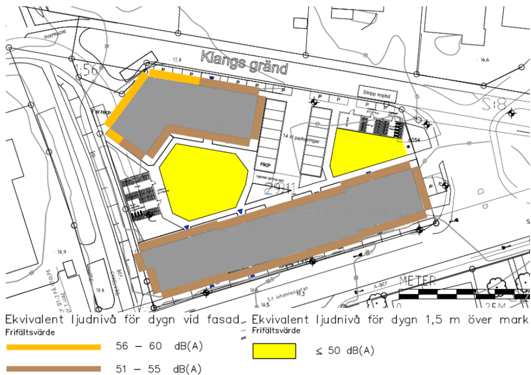
Figur 32 Utdrag ur trafikbullerutredningen, som visar den beräknade ekvivalenta ljudnivån vid fasad och 1,5 meter över mark för år 2030, Åkerlöf Hallin Akustikkonsult AB.
