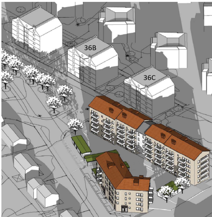
Figur 40 Solstudie som visar hur ny bebyggelse skuggar befintliga byggnader på S:t Johannesgatan vid midsommar klockan 20, A-sidan arkitektkontor AB.
